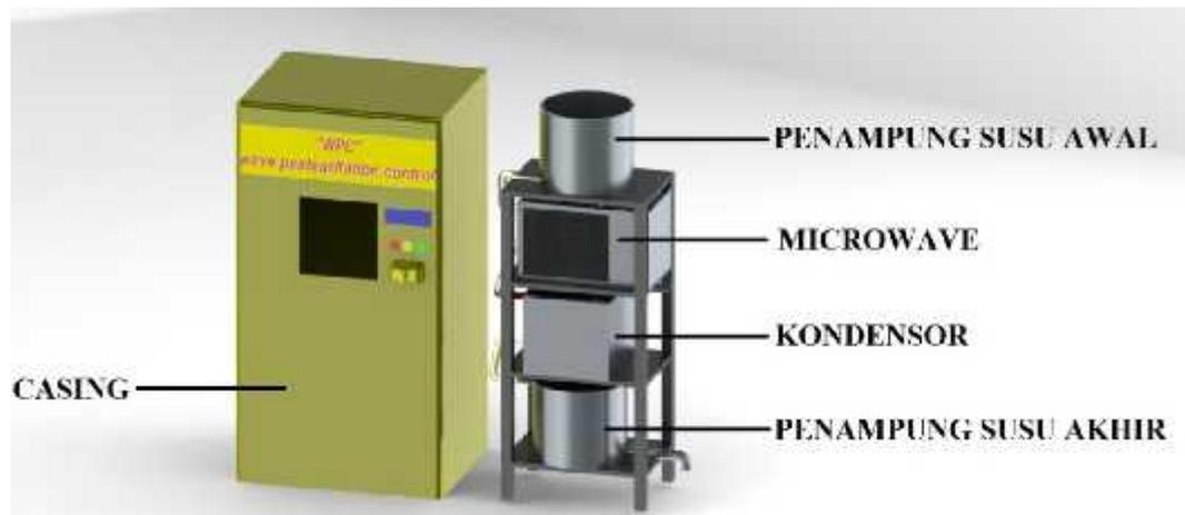
Desain alat ini bertujuan untuk mempersingkat waktu yang dibutuhkan untuk pasteurisasi dan kountinyunitas alat dapat dipastikan efisien karena susu dalam alat akan mengalir dari pendinginan langsung ke pengemasan. Dengan menggunakan gelombang mikro berbasis sistem kontrol otomatis. Pendinginan
